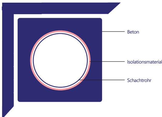
**Vor dem Verschließen der Deckenaussparung**
